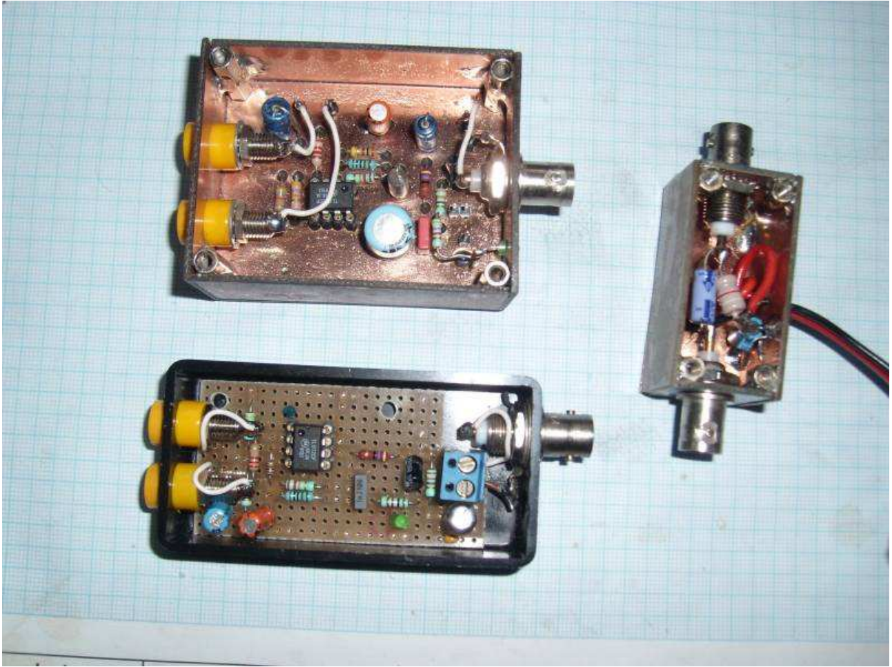
OZ5JAN's eksemplarer af Loopantenneforstærkere med strømtilførselsenhed
